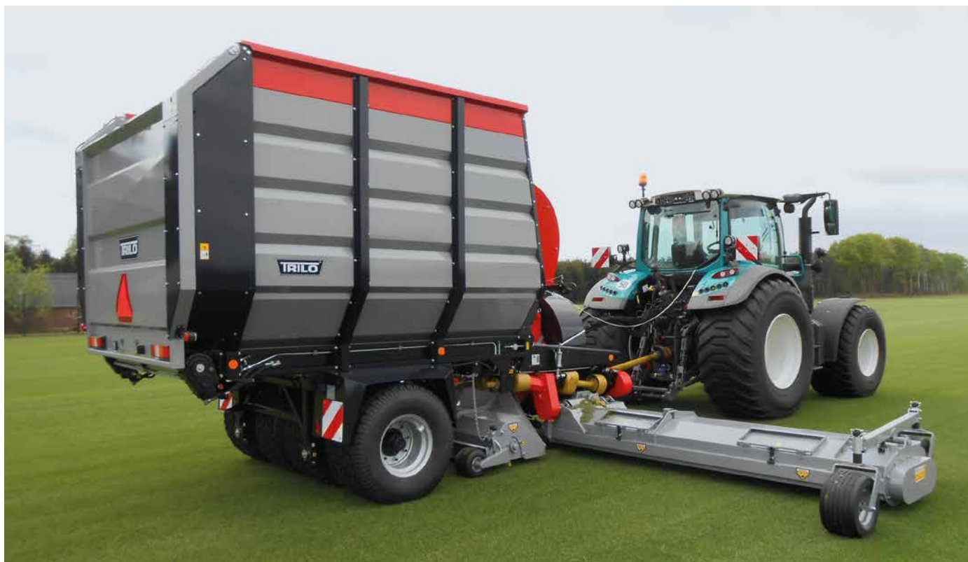
TRILO grote wide-area sweep & Collect zuigwagens met wings voor het vegen en verzamelen van grote terreinen.
