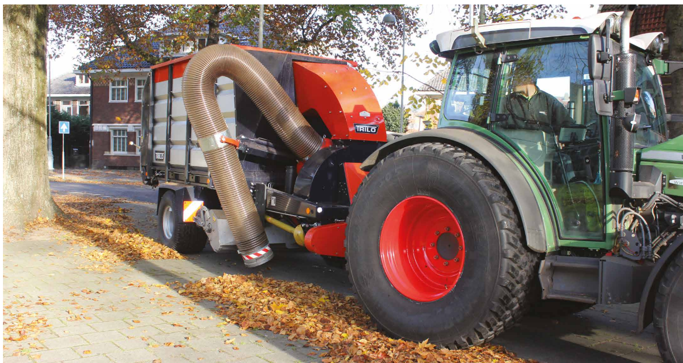
Een voorbeeld van een TRILO M10 zuigwagen aan het verticuteren en verzamelen met een werkbreedte van 2.1 m. Met een zuigslang zijn M-Serie zuigwagens ook inzetbaar voor andere werkzaamheden op sportfaciliteiten.
