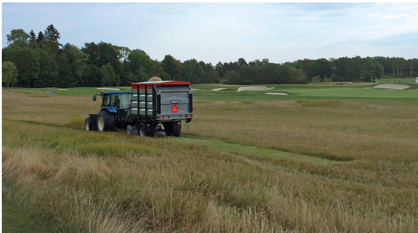
Een TRILO C8 maaizuigwagen maait en verzamelt met een hoge werksnelheid in één werkgang 'the Rough'.
