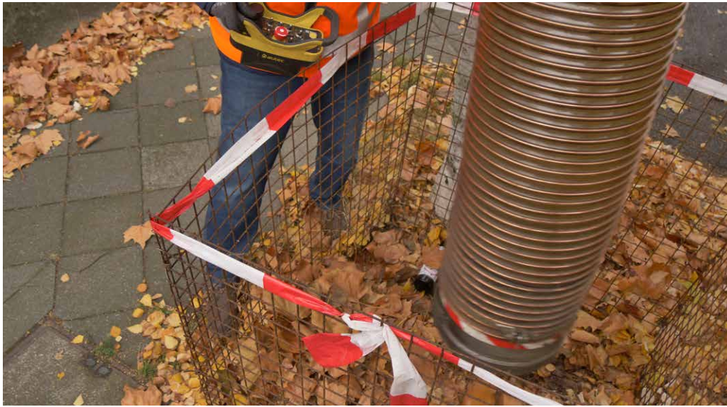
Een pendelautomaat beweegt de zuigslang heen en weer voor beter opzuigen van materialen.
