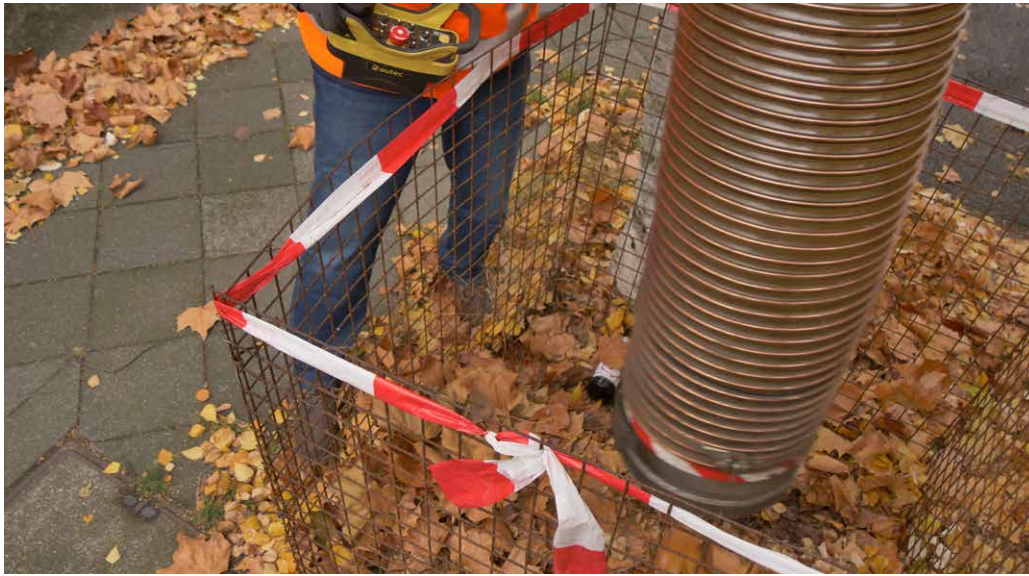
Une navette automatique déplace le tuyau d'aspiration d'avant en arrière pour une meilleure aspiration.
