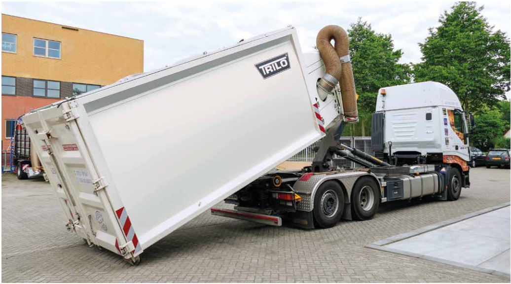
Attelage et décrochage simple grâce au système de levage à crochet.
