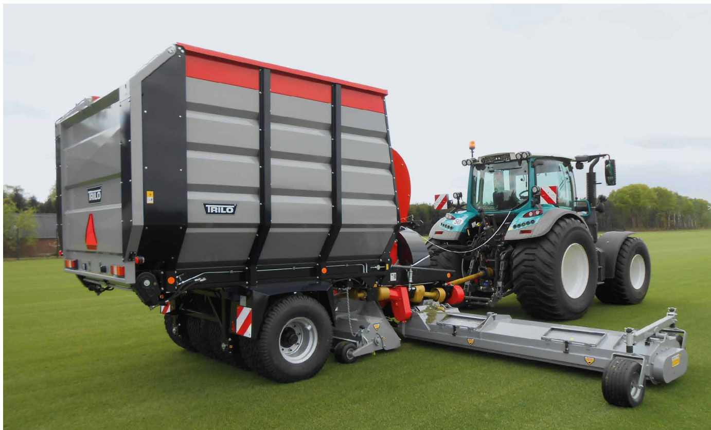
Grandes balayeuses aspiratrices TRILO avec des ailes pour le balayage et la collecte de grandes surfaces.
