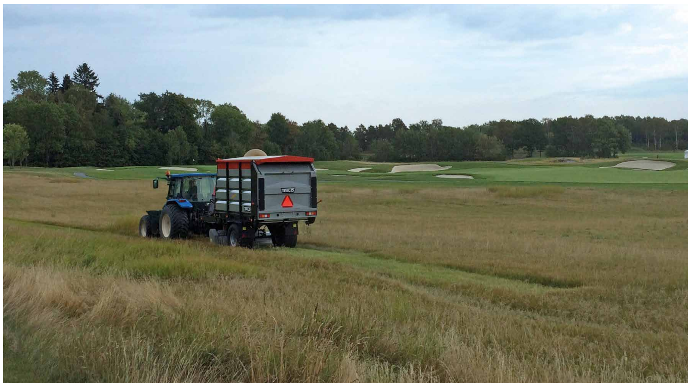
Une balayeuse aspirante TRILO C8 cut & collect tond et ramasse le brut en un seul passage.
