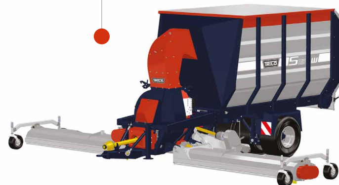
Balayeuses aspirantes TRILO Wide Area Sweep & Collect avec ailettes pour le balayage et le ramassage de grandes surfaces sur les terrains de golf.
