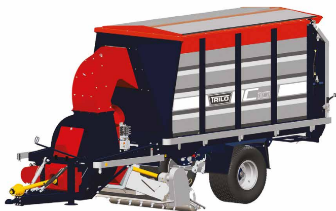
Une balayeuse aspirante TRILO C8 cut & collect tond et ramasse le brut en un seul passage.
