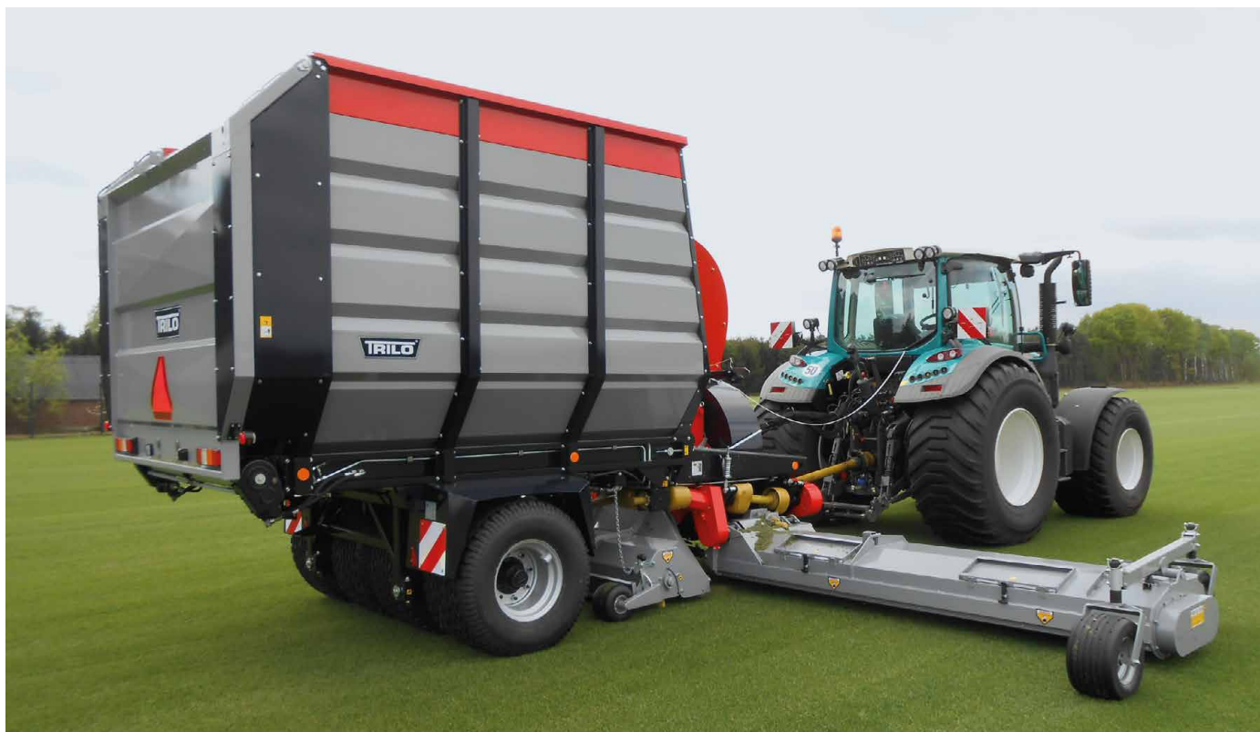
Balayeuses aspirantes TRILO Wide Area Sweep & Collect avec ailettes pour le balayage et le ramassage de grandes surfaces sur les terrains de golf.
