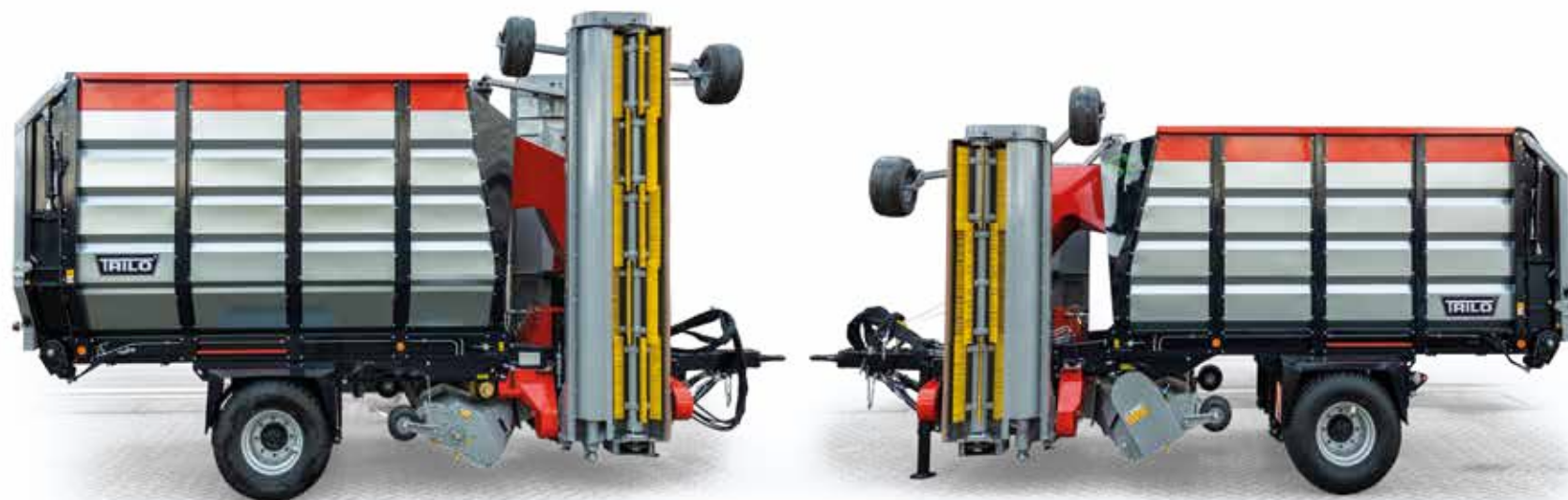
Les capteurs TRILO Wide Area avec ailes ont des largeurs de travail de 5.8 ou 7.8 mètres.
