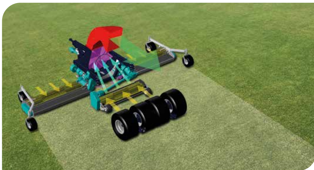
Le principe de fonctionnement des ailes du collecteur d'herbe de grande surface.
