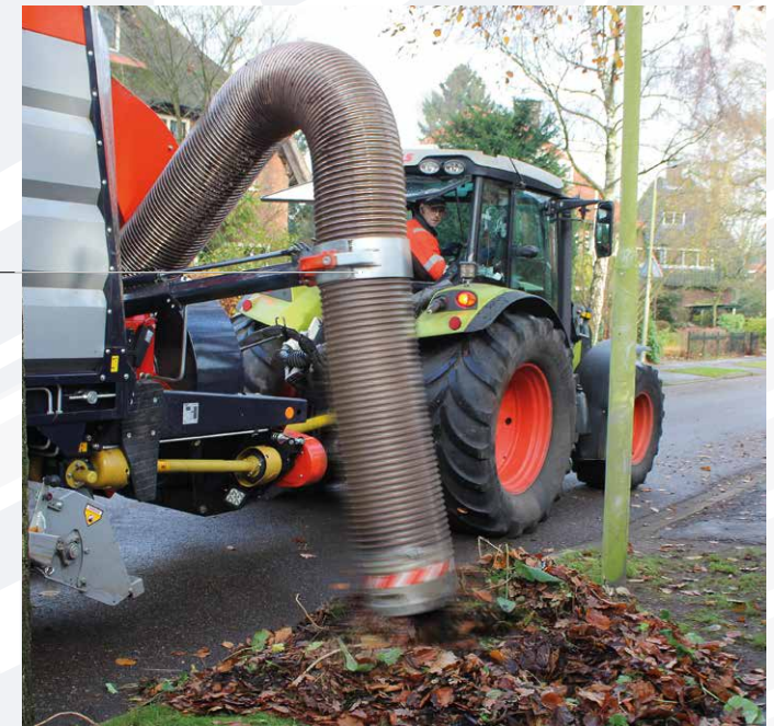
Bedienung des Saugschlauchs mit der Joysticksteuerung.
