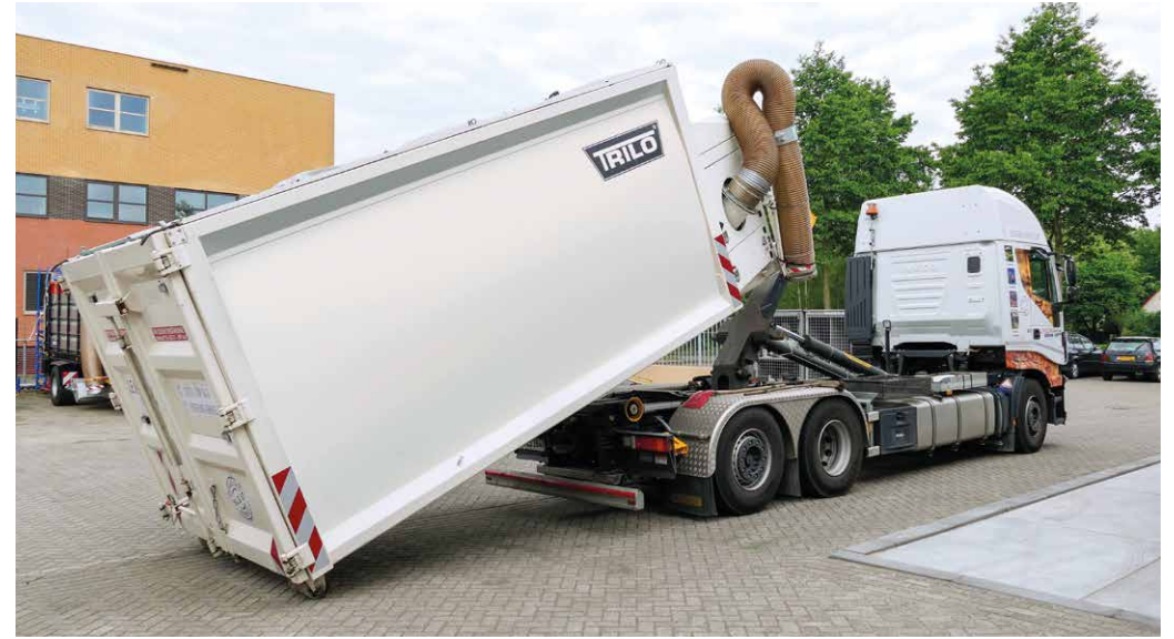
Einfaches Auf- und Abladen mit einem Hakenliftsystem.
