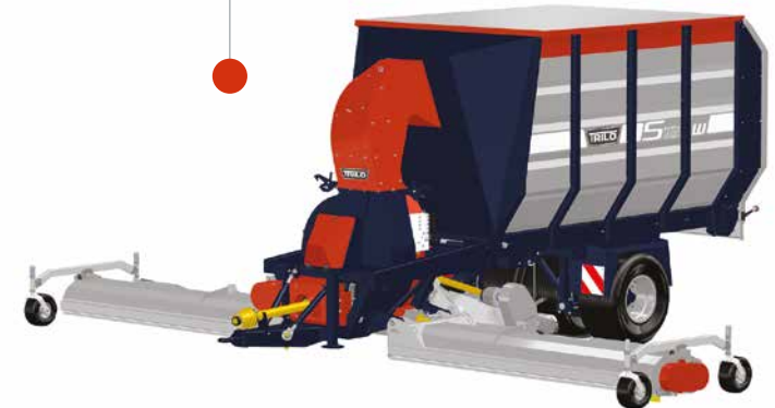
Große Kehrsaugwagen mit Seitenauslegern zum Aufsammeln von Grasresten oder vertikutier Rückständen von großen Flächen.
