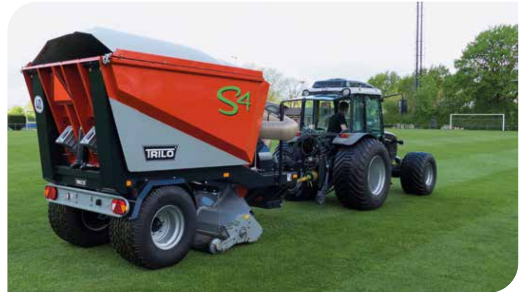
Vertikutieren und saugen in einem Arbeitsgang mit dem S4.
