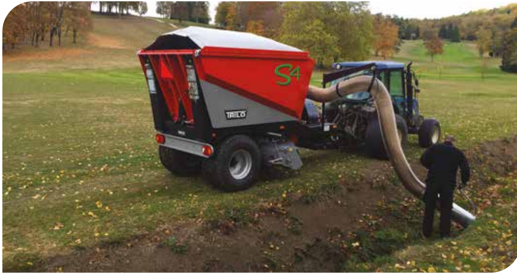
TRILO Saugwagen können optional mit einem Saugschlauch ausgestattet werden.
